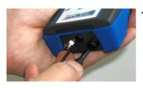
1.) Erdungs-Messspitze (3) an Steckverbindung (11) anschließen.
